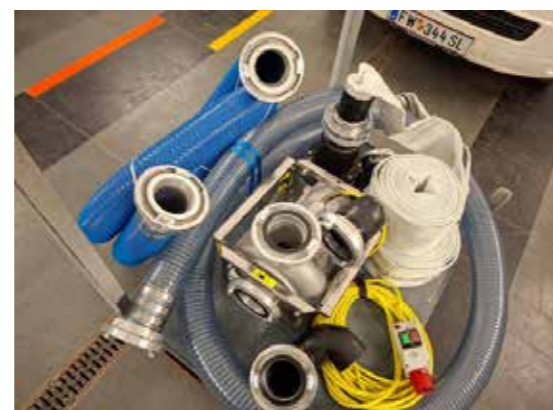
Im Bild: Spechtenhauser Chiemseepumpe groß (Storz A), formstabile Schläuche, Druckschläuche, Ansaugköpfe.
